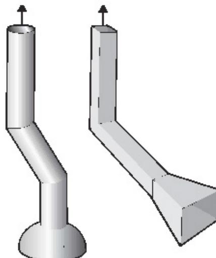
Teóricamente la velocidad de captación necesaria depende de la velocidad de producción del contaminante, su peligrosidad, su temperatura, su densidad, y de la existencia o no de corrientes de aire que interfieran. En la práctica, y en líneas generales, la retirada eficaz de gases o vapores exige velocidades de captación del orden de los 0,6-0,7 m/s en su zona de generación.
