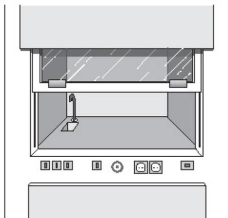
Por otra parte, elementos tales como tuberías, sifón, conductos, sirgas, contrapesos, etc. deben encontrarse fácilmente accesibles de modo que se faciliten las necesarias revisiones periódicas y el adecuado mantenimiento.
